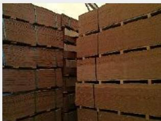
Diese Platte eignet sich für die Oberflächenveredelung mit Melaminharzpapier, Lack, Folie und vielem mehr. Im Rohzustand hat sie eine glatte Seite an der Oberseite und eine Siebstruktur auf der Rückseite. Die Farbe der Platte ist braun. Die Entsorgung der Biofaserplatte ist unproblematisch.
