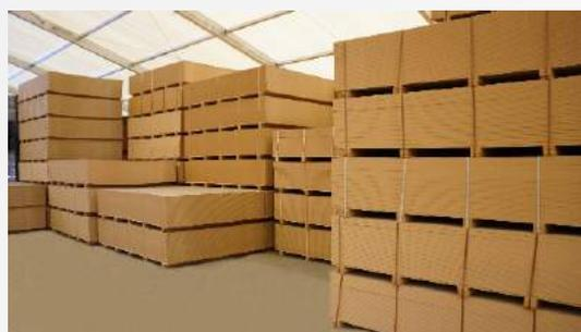
Сухой метод производства плиты HDF позволяет обеспечить идеальную поверхность для окраски. Его закрытая поверхность позволяет значительно снизить расход красок и лаков. Сырая доска HDF может быть успешно оклеена декоративными пленками, также
